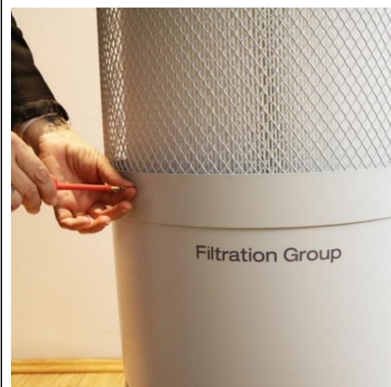
3.) Sicherungsschrauben am Gehäuse lösen.
