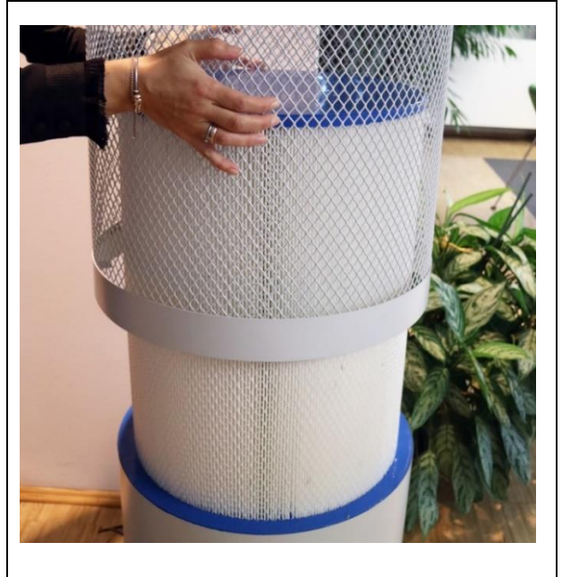
4.) Gehäusegitter entfernen
