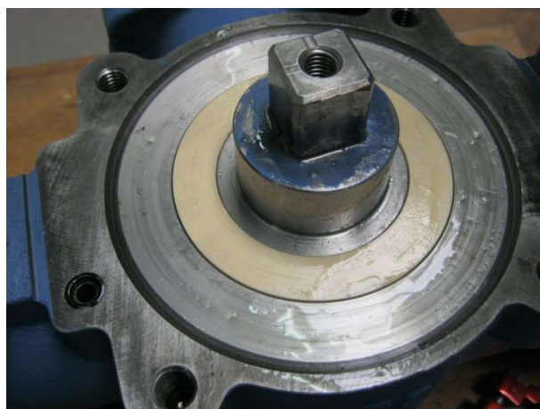
Umschaltwalze mit Anlaufscheibe. Links der O- Ring von der Druckausgleichsleitung.
