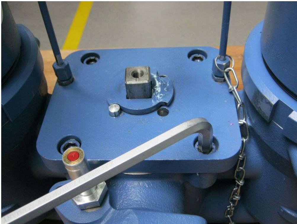
Öffnen der Schrauben mit einem Inbusschlüssel SW 12 Opening of the screws with an hex-wrench, wrench size 12 mm
