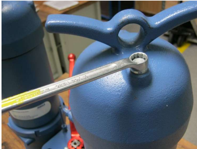
Entlüftungsschraube zur Druckentlastung öffnen Open the vent screw to release the pressure
