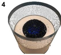
Holzbodenplatte, Bodenschallmatte und Lochschallmatte aus dem Gerät herausnehmen.
