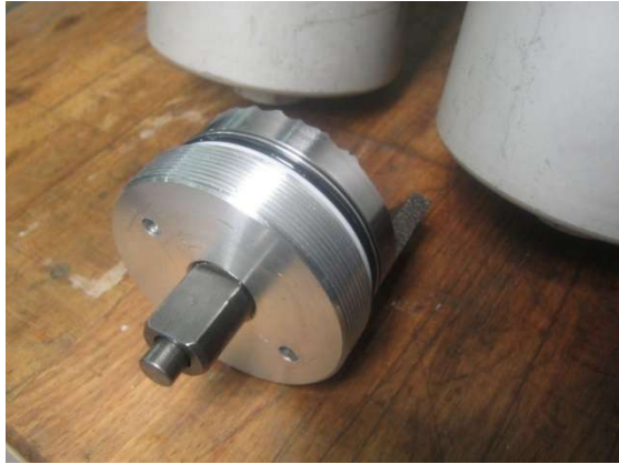
Das ausgebaute Umschaltkúken mit Deckel. The dismantled plug valve with cover.
