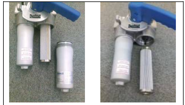
Fig. 15: ボウルとエレメントを外します
